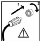
¡Importante! Para evitar dañar los enchufes y los cables, es necesario un buen contacto al conectar a la máquina el cable de retorno y la antorcha de soldadura
