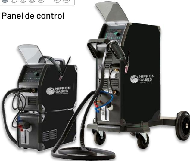
Inverter para soldadura TIG ACDC con cebado por contacto o por Alta Frecuencia y MMA.
