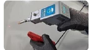
Las pinzas de cocodrilo están conectadas al cable de tierra para evitar la salida accidental de luz, por lo que se deben anclar a la mesa de trabajo si es metálica, si no lo es conecte las pinzas directamente a la pieza del material a soldar.
