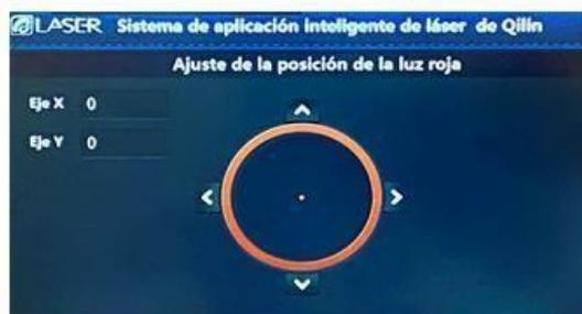
Ajuste el eje de la lente reflectora del motor X e Y para cambiar la posición de desplazamiento de la luz roja.
