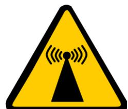
Los campos electromagnéticos generados por máquinas de soldadura pueden causar interferencias a otros dispositivos. Pueden afectar marcapasos cardíacos.
