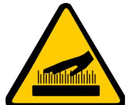
Las partes calientes pueden provocar quemaduras. La pieza de trabajo, las proyecciones y las gotas están calientes. Utilice guantes, delantales, zapatos de seguridad y otros equipos de seguridad individual.
