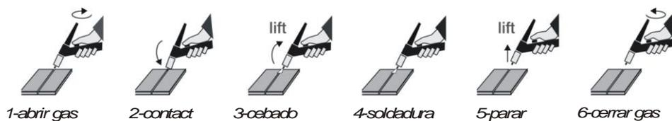
Este proceso se usa en locales donde la emisión de ondas de alta frecuencia puede afectar el funcionamiento de aparatos electrónicos sensibles tales como ordenadores, aparatos hospitalarios, marcapasos cardíacos, etc.
