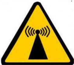
Los campos electromagnéticos generados por máquinas de soldadura pueden causar interferencias a otros dispositivos. Pueden afectar marcapasos cardíacos.
