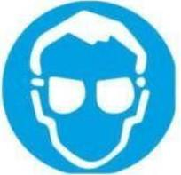
Es indispensable proteger los ojos contra las radiaciones del arco eléctrico. Utilice una pantalla de soldadura con un filtro protector adecuado.
